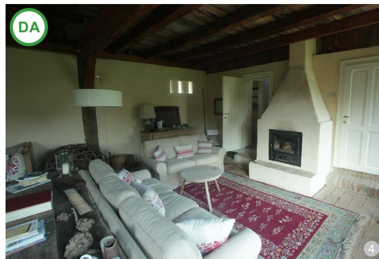
**ASA DA:** Semineele sunt corpuși de încălzire care, în afară de funcția de destindere pe care o au, pot fi introduse cu succes în circuitul sistemului de încălzire al clădirii. Există seminele din otel cu funcționare pe peleți și ventilație forțată, termoșemine, potrivite pentru locuințe moderne, eficiente energetic, cu sistem de recuperare. În afară de încălzirea apei, termoșeminele nu generează doar o căldură plăcută în interior, ci creează, de asemenea, o atmosferă confortabilă.
