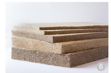
Saltele termoizolante din fibre de cânepă
