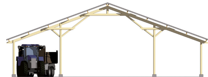
Soluția structurală cu sprijiniri intermediare, asigură un gabarit uniform în interiorul clădirii dar fluxurile tehnologice și manevrabilitatea utilajelor este restrânsă de prezența stâlpilor intermediar
