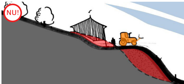
ASA NU: Platforma curtea de lucru iese mult în rambleu, este expusă vederii și eroziunii
