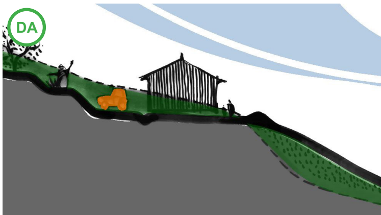
ASA DA: Pentru crearea unei platforme s-a evitat realizarea unui zid de sprijin costisitor prin implementarea unor terase intermediare care necesită soluții mai simple și mai ieftine de stabilizare. Pământul scos din debleu a fost folosit pentru refacerea pantei naturale a terenului.
