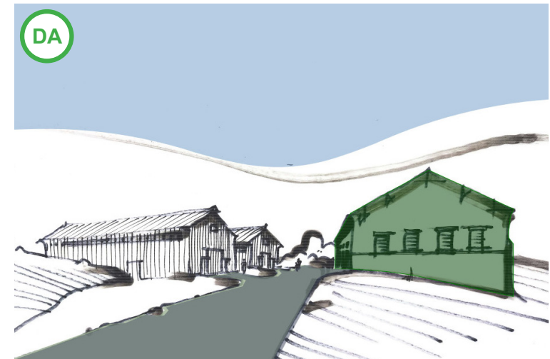
ASA DA: Construcția agricolă pe două niveluri sprijina platforma curții de lucru
