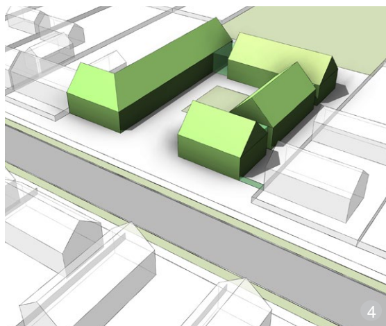
Principiu de amplasare a construcțiilor: vedere aeriană. Tipologie de clădiri contemporane încadrate în specificul local, cu aliniere la stradă și un front întrerupt în zona centrală, pentru crearea accesului în curtea deschisă spre spațiul public. Volumele sunt dispuse în jurul unei curți, în sistem pavilionar.
