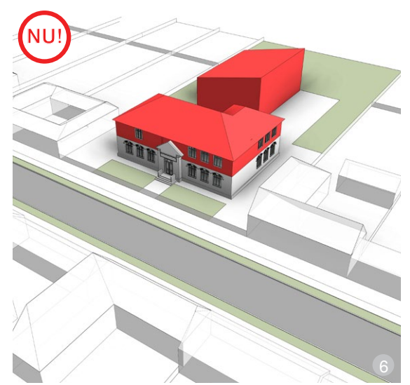
Amplasarea construcției: vedere aeriană. Extindere cu un volum neadecvat, negarea curții, etajare fără a ține cont de scară, de specificul locului sau de proporții.
