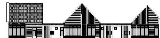
AȘA DA: Pentru filtrarea vizuală a zonelor destinate grupurilor sanitare, s-au realizat umbrare verticale din lemn, integrate în ritmul finisajelor fațadei..
